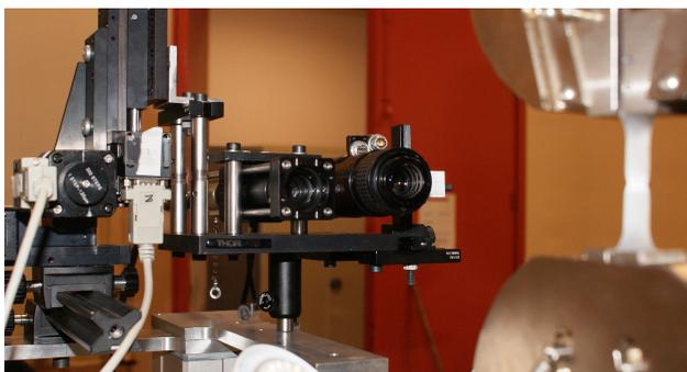
Figure: Photo du montage expérimental – Spectromètre Raman VidéoTraction
